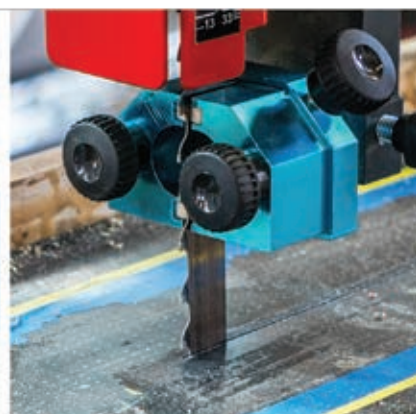
Keramické vodidlá pílového pásu
