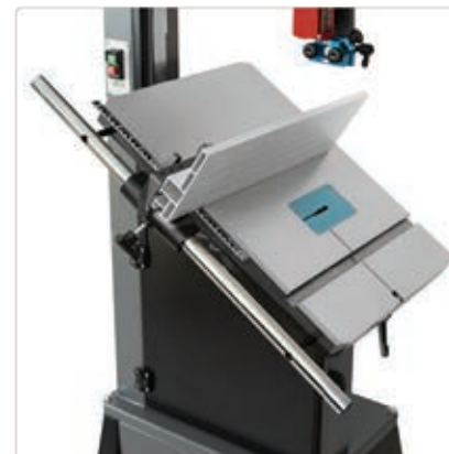
Naklonenie stola od -7^{\circ} do +45^{\circ}
